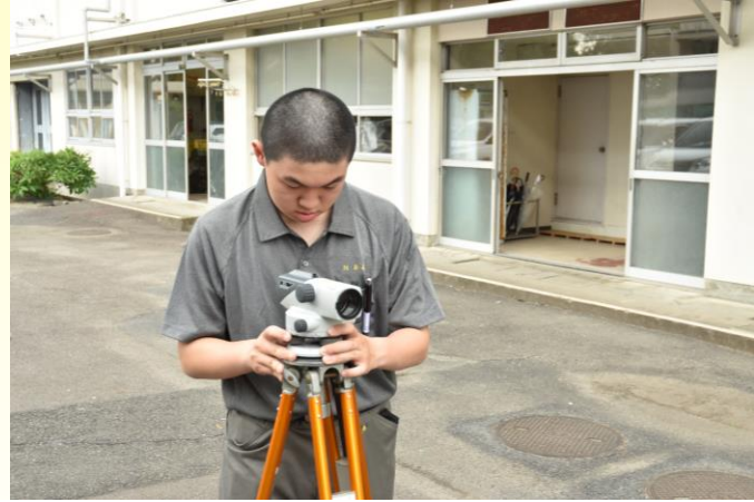
水準測量実習（オートレベルを用いて高低差をもとめています）
